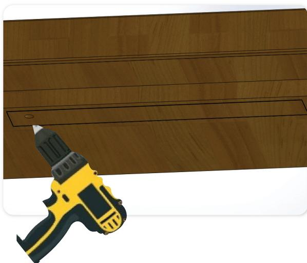
Parafuse a base do fecho na madeira. São necessários 9 parafusos para a fixação da peça, que são fornecidos no conjunto do fecho.
